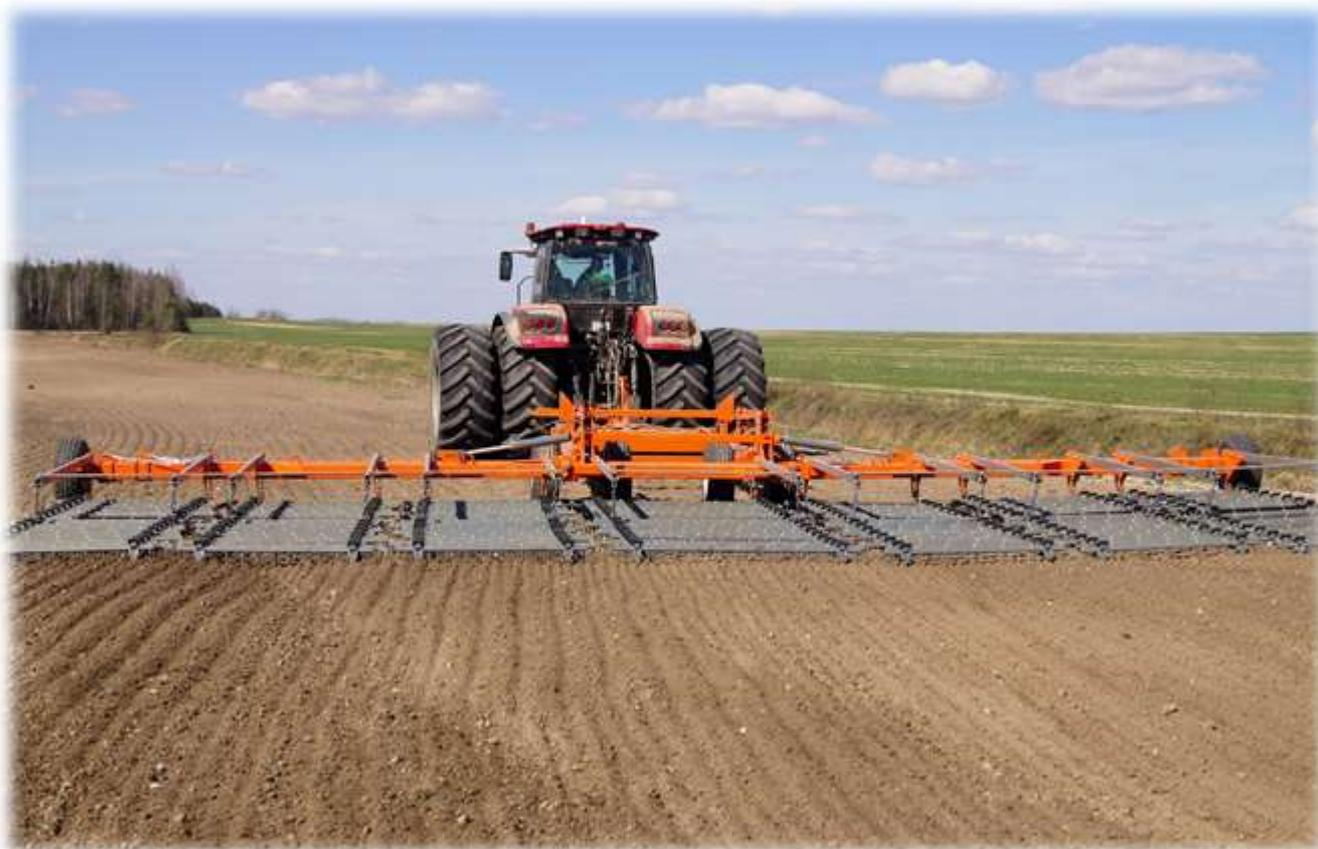
Зубовая шлейф-борона TIREX обрабатывает почву шириной до 15 м за один проход. Частое расположение зубов бороны позволяет получить высочайшее качество предпосевной обработки почвы.
